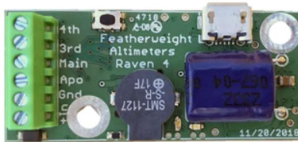
**Fig. 121 Raven 4 altimeter**
