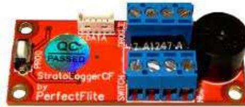
**Fig. 120 Stratologger CF altimeter**
